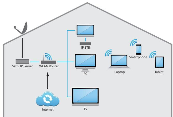
**Die Verteilung erfolgt über einen Router, der die unterschiedlichsten Signalwege bedienen kann.**
